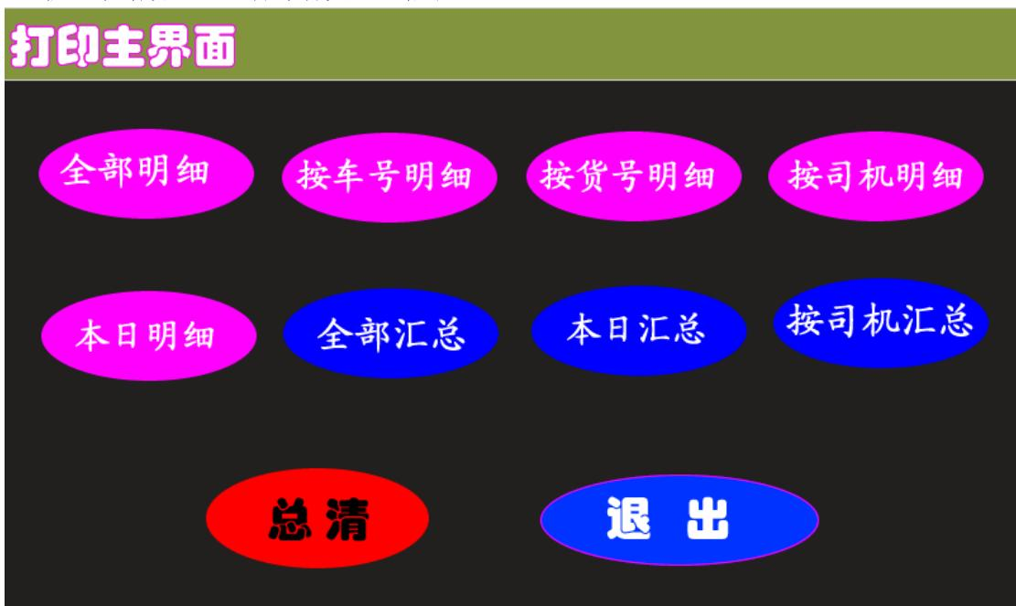
其中“按车号明细”、“按货号明细”、“按司机明细”、“按司机汇总”的打印应先在称重界面设置要汇总打印的车号或货号、司机号，然后进入本打印界面按相应按钮既可。
