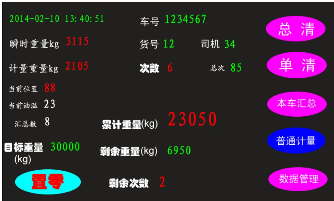
定量装载时需按目标重量后面的绿色数字输入目标值（单位：kg），衡器会自动显示剩余重量和剩余次数（估计值），到目标值后仪表会自动给出提示：
