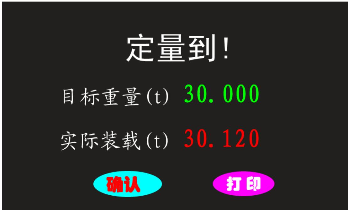
按“确认”返回定量称重界面，可以继续装载；按“打印”则结束本次装载打印汇总结果并返回定量称重界面。
